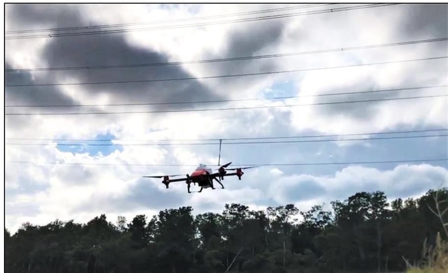
P30本体にはRTKアンテナが2本装備されており、2本のアンテナを同時に利用して機体の方向を把握するシステムとなっています。
