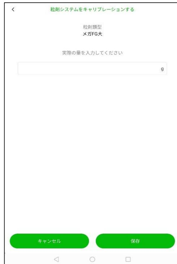
入れた粒剤がローラー何回転でどれくらい落ちるかを学習し、実際に散布する際の飛行条件によって自動で可変します。
